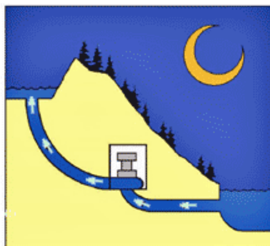
Рис. 2. Ночь: вода накачивается в гору в резервуар для завтрашнего использования
