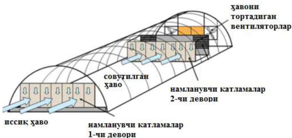
1 расм. "Намланувчи катламалар" асосида буғлатиб совутиш тизимига эга гул иссиқхонасининг кўриниши
