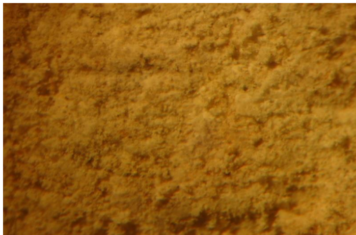
1.1–rasm. Pishiq g‘isht bo‘lagi namunasining mikroskopik tasviri (100 marta kattalashtirilgan)
