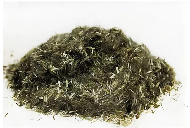
2-расм. Базальт толасининг умумий кўриниши тасвирланган.
