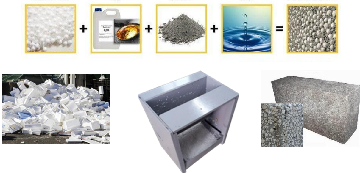
1-rasm: Polistrol betonni sanoat chiqindilaridan olish texnologik sxemasi
