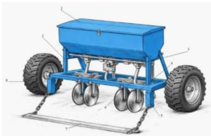
Rasm 1. Tavsiya etilayotga 70 sm qator oralig'iga mo'ljallangan no'xat ekish seyalkasi
