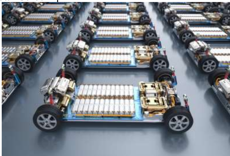
2-rasm. Elektromobil platformasida batareya modullarining joylashuvi va elektr yuritma tizimi tuzilishi
