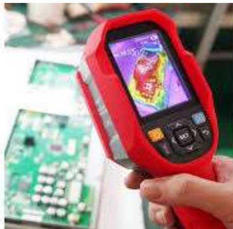
1-rasm. Issiqlik chiqish nuqtalarini aniqlash qurilmasi (teplovizor)
