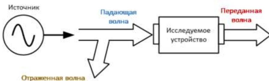
Рис. 2 Распространение сигнала по измерительной цепи
