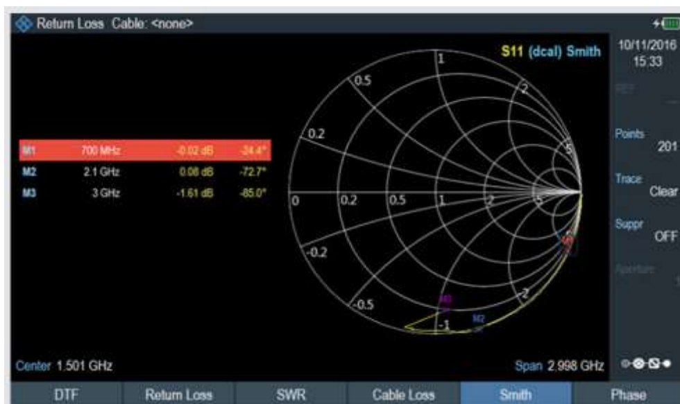
Рис. 6 Отображение диаграммы Вольперта-Смита на экране прибора ZPH
