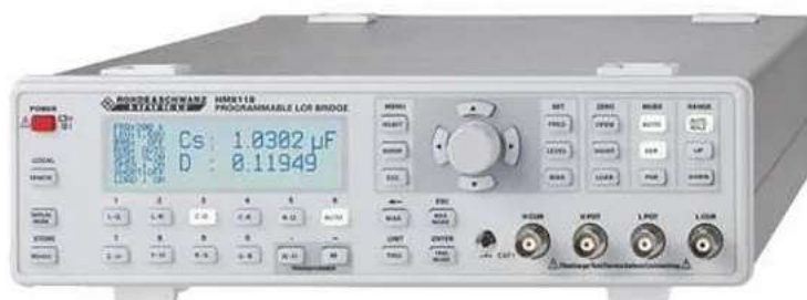
Рис. 3 Фото передней панели LCR-метра Rohde Schwarz LCR HM8118
