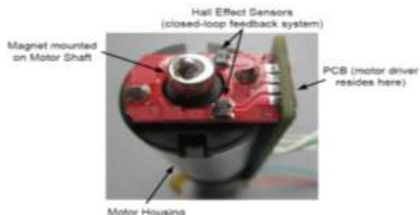
3- rasm . Magnit va Holl effektlı sensorlar yordamida motor.
