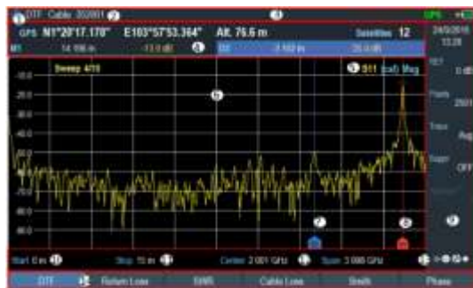
Рис.5 Диалоговое окно в режиме измерений "Antenna & Cable"
