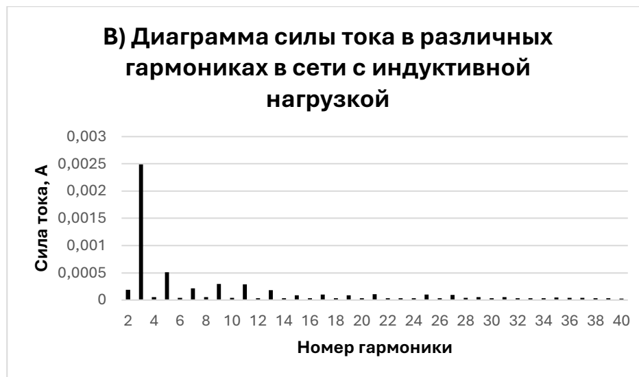
Рис. 4. Сила тока в различных гармониках: А) активная нагрузка, Б) емкостная нагрузка, В) индуктивная нагрузка.
