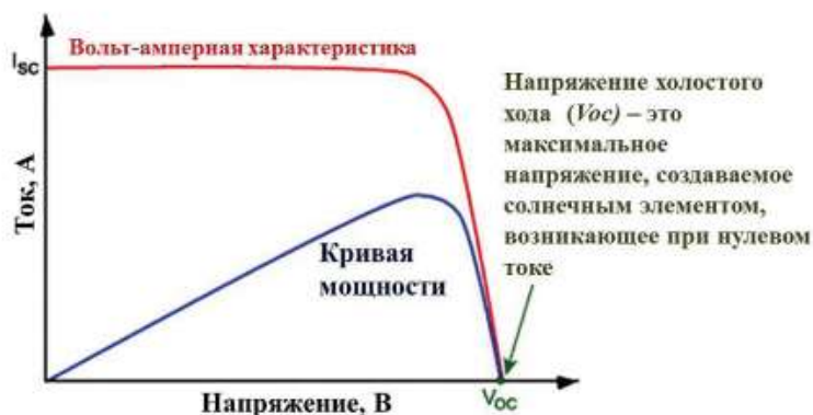
Рисунок 2. Вольт-амперная характеристика солнечного элемента и напряжение холостого хода
