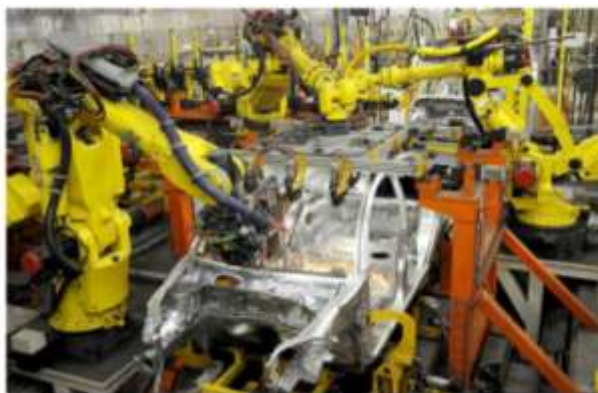
5- rasm . Robotik payvandlash juda aniq vosita boshqaruvini talab qiladi.
