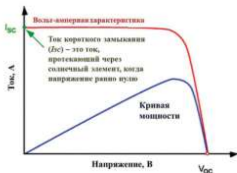
Рисунок 3. Вольт-амперная характеристика солнечного элемента и ток короткого замыкания
